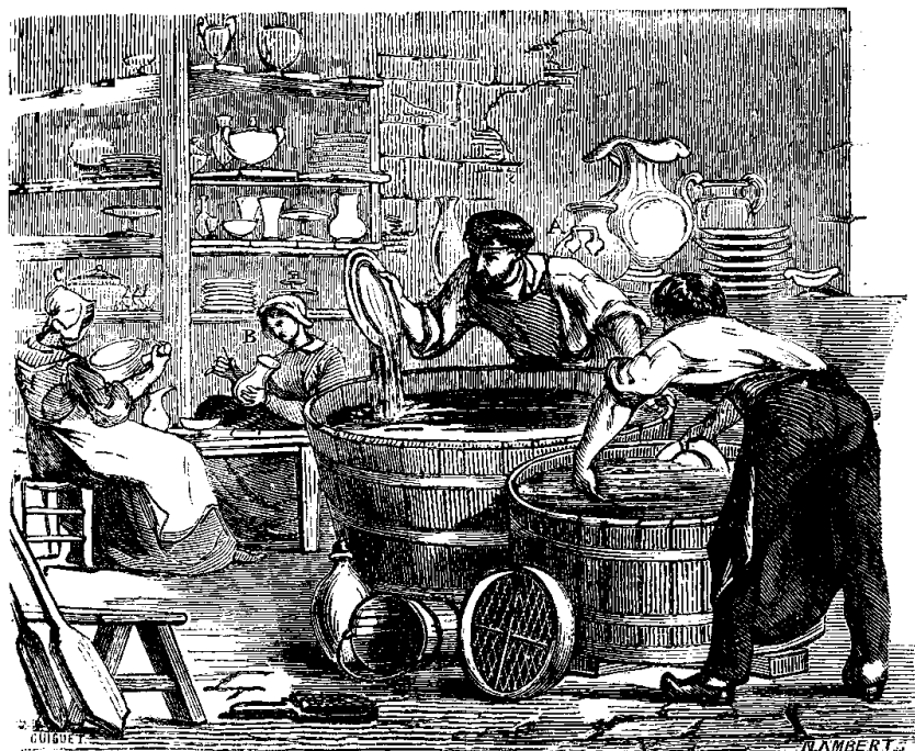
Fig. 4. — Atelier de trempage dans la barbotine.
